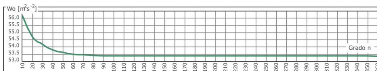
Figura 3. Dependencia de W_0 en función del grado de expansión n del GGM utilizado, el valor 62\,636\,800 \text{ m}^2\text{s}^{-2} debe ser adicionado (Sánchez 2005).
