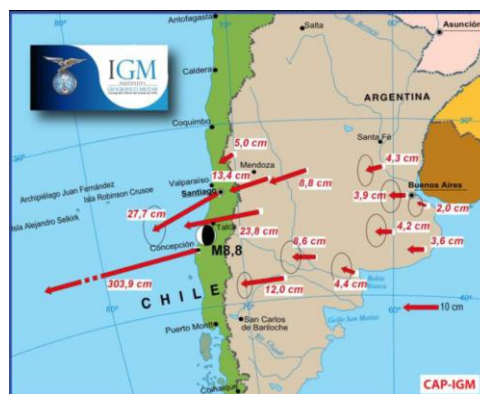
Figura 12. Vectores de desplazamiento calculados por el Instituto Geográfico Militar de Chile después del terremoto del 2010-02-27 (tomado de [36]).
